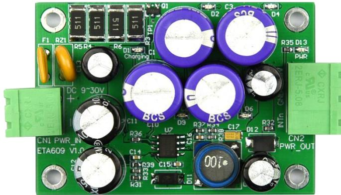
ETA605 上的 D6、D8 是超级电容故障或过压指示 LED,可在模块上电 10 分钟后观察,如果其中任何一颗指示灯亮,此模块就不能使用。
