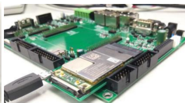
ETA310 模块插在 mini PCI-e 插座上
