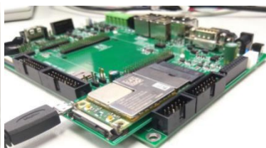
ETA310 模块插在 mini PCI-e 插座上
