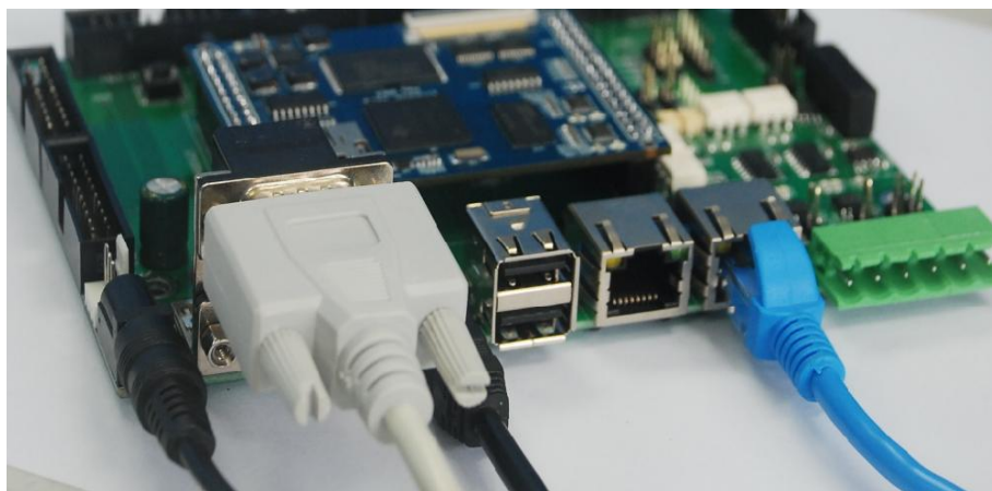
图 2_6：连接电源适配器，给系统上电
