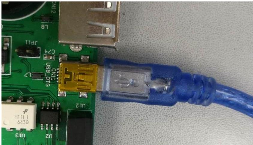
图 1、连接 ESM6802 的 USB\_OTG 口
