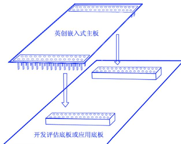
客户的应用底板的基本功能包括向 EM9260 供电、引出所需的各个通讯接口、扩展专用的应用电路单元等等。应用底板的尺寸以及接口所处位置则与整机产品的接口密切相关。另外整机的电磁兼容性也会在应用底板上有所体现。
